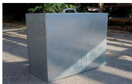
Шумоизоляционный кожух для агрегата
