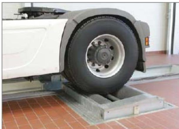
Роликовая секция с подъемным устройством
