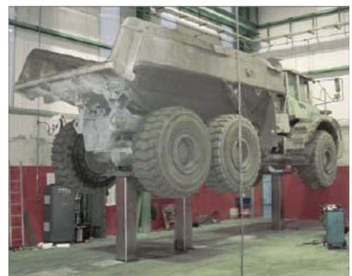
OMNI LIFT 3.25 SHV – 3-плунжерная подъемная система
