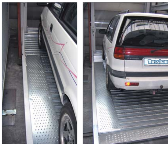
Проходы Располагается на левой стороне платформы для комфортного прохода. 1,5 мм оцинкованная пластина, тисненная поверхность. Пластина прикручивается к поверхности платформы, с коррозионной защитой „Classic“ или „Classic Plus“. Габариты: 350 см x 31/41 см (Д x Ш)
